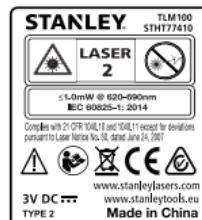
Das Werkzeug STHT1-77409/STHT1-77410 gibt einen sichtbaren Laserstrahl aus, siehe Abbildung A. Der ausgegebene Laserstrahl entspricht Laserklasse 2 gemäß IEC 60825-1 und erfüllt 21 CFR 1040.10 und 1040.11, außer bezüglich Abweichungen gemäß Laser Notice No. 50 vom 24. Juni 2007.
