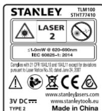
STHT1-77409/STHT1-77410 værktøjet udstråler en synlig laserstråle som vist på ill. A. Laserstrålen hører under laserklasse 2 iht. IEC 60825-1 og er i overensstemmelse med 21 CFR 1040.10 og 1040.11 med undtagelse af afgivelser iht. Laser Notice No. 50 fra juni 24, 2007.
