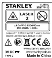
Verktøyet STHT1-77409/STHT1-77410 avgir en synlig laserstråle, som vist i figur A. Laserstrålen som avgis er i laserklasse 2 iht. IEC 60825-1, og samsvarer med 21 CFR 1040.10 og 1040.11, med unntak av avvik iht. Laser Notice No. 50 datert 24. juni 2007.
