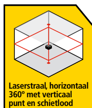
Laserstraal, horizontaal 360° met verticaal punt
