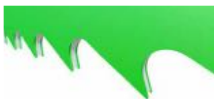
Meerdere zaagranden / gespleten spanen
