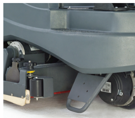
Zowel het schrobdek als de zijkanten van de zuigmond worden goed beschermd door grote rolbumpers
