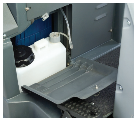
Het reinigingsmiddel zit nu onder de bestuurderstoel waardoor deze nog eenvoudiger kan worden vervangen
