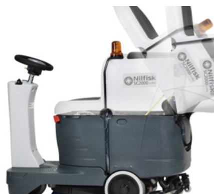
Volledig draaibare opvangbak voor goed bereikbaar batterijvak en Ecoflex-systeem
