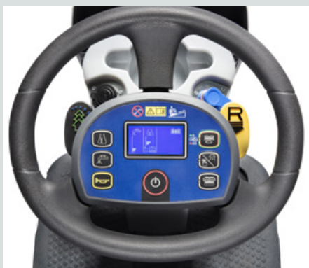
Bedieningsgemak: extreem gebruikersvriendelijk en gemakkelijk te bedienen. Dashboard met One-Touch knop en intuïtieve display, geïntegreerd in het stuur
