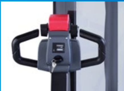
Ergonomischer Deichselkopf mit Batterie- und Betriebsstundenanzeige
